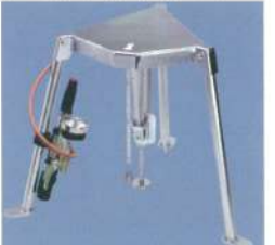
簡易支持力試験機 (エレファント) 施工前に地盤支持力の安全を確認!
