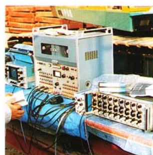
圧電型加速度計による振幅測定
